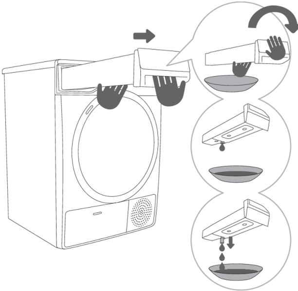
**1** Ziehen Sie den Kondenswasserbehälter mit beiden Händen aus dem Gerät heraus (siehe Abbildung) und entleeren Sie ihn in das Waschbecken.
