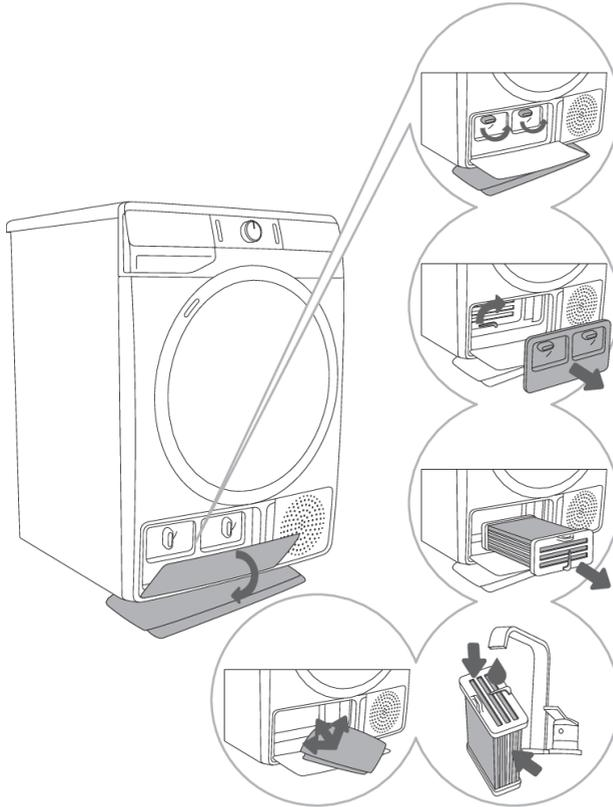
**1** Öffnen Sie den Außendeckel. Fassen Sie die Griffe am Innendeckel an und drehen Sie sie nach oben.
