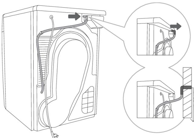
**1** Hebeln Sie mit einem Schraubenzieher den Schlauch aus dem Stutzen auf der Rückseite des Geräts (links unter der Abdeckung) heraus.
