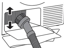
**6** La polvere e lo sporco nelle lamelle dello scambiatore di calore possono essere puliti con aspirapolvere e usando prolunga con spazzola d'aspirazione morbida.
