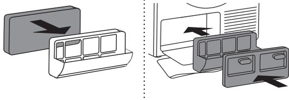
**7** Rimontare il filtro in schiuma e l'alloggiamento del filtro.
