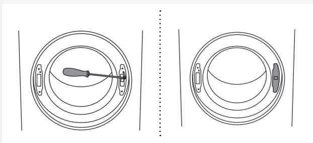
**5** Avvitare la vite nella serratura dell'oblò.
