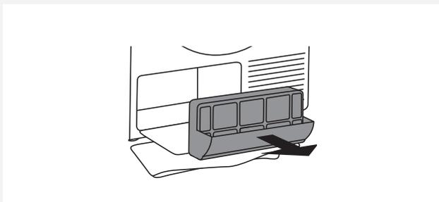
**3** Utilizzando la maniglia estrarre il filtro della pompa di calore.
