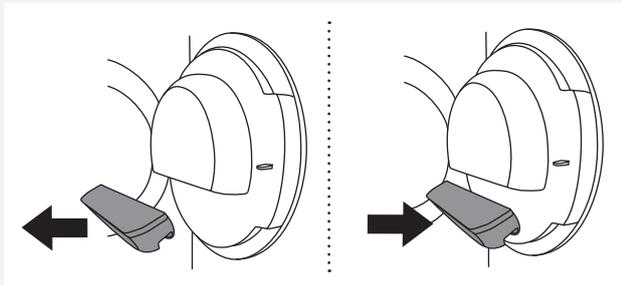
Nel caso in cui sia stato rimosso, involontariamente, l'alloggiamento **intero** del filtro a rete dell'oblò, reinserirlo nella stessa posizione.
