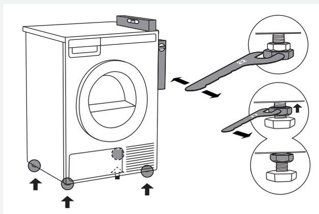
Posizionare l'asciugatrice in modo tale che sia stabile. Utilizzare una livella e bilanciarla sia longitudinalmente che trasversalmente ruotando i piedini regolabili con la chiave inglese n. 22 (massimo 15 mm). Quindi, stringere i controdadi con la chiave inglese n. 17 verso il fondo dell'apparecchio ↑.
