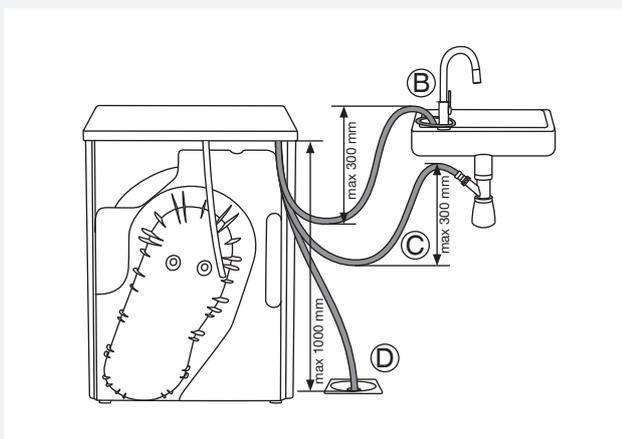
**2** Alla stessa bocchetta (A) collegare il tubo di scarico di gomma in dotazione.
