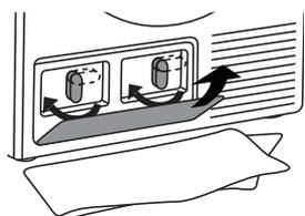
**8** Installare il coperchio interno e ruotare le leve in senso orario in posizione verticale. Chiudere il coperchio esterno.
