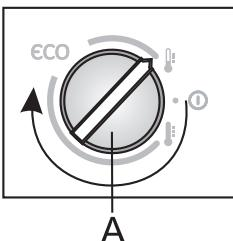
Když je teplota v místnosti, ve které je zařízení nainstalováno nižší než 16 °C, doporučujeme nastavit **A** na .
