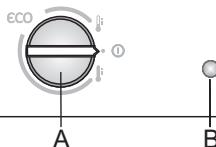
**A Spínač VYP/ZAP + nastavení teploty**
