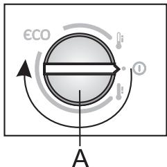
**Zapnutí:** Pro zapnutí otočte spínačem **A** po směru hodinových ručiček.
