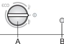
**A Gumb za nastavitev temperature in vklop/izklop aparata**
