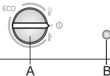
**A Gumb za uključenje i isključenje uređaja, odnosno gumb za ugađanje temperature u uređaju**
