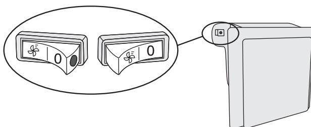
Kada je ventilator uključen, na prekidaču je vidljiva crvena točka.
