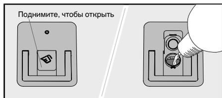
1. Откройте крышку отделения автоматического дозирования, чтобы добавить гель для мойки в посудомоечных машинах.
