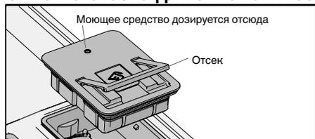
1. Отсек можно вынуть для очистки и заправки.
