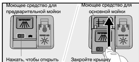
Не добавляйте моющее средство в отделение для ручного дозирования при использовании автоматического дозирования моющих средств! Слишком большое количество моющего средства ухудшает результат мойки и отрицательно влияет на окружающую среду.
