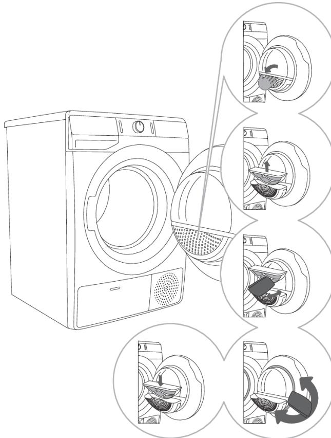
**1** Otvorite kućište filtera.
