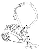
Pentru a conecta furtunul de aspirare: introduceți furtunul de aspirare în orificiu.
