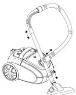
Για να συνδέσετε τον σωλήνα αναρρόφησης: εισαγάγετε τον σωλήνα αναρρόφησης στο άνοιγμα.
