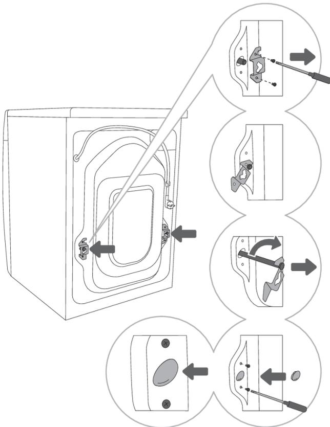
**1** Écartez les tuyaux et retirez les vis à l'arrière de la machine. Enlevez les deux brides de fixation.
