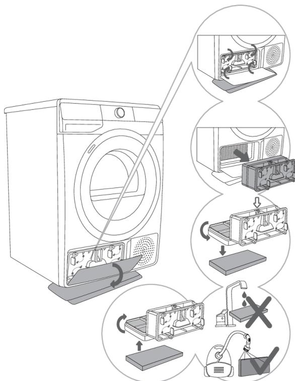
**1** Ouvrez le couvercle extérieur. Maintenez les leviers sur le couvercle intérieur et faites-les tourner comme indiqué par les flèches.
