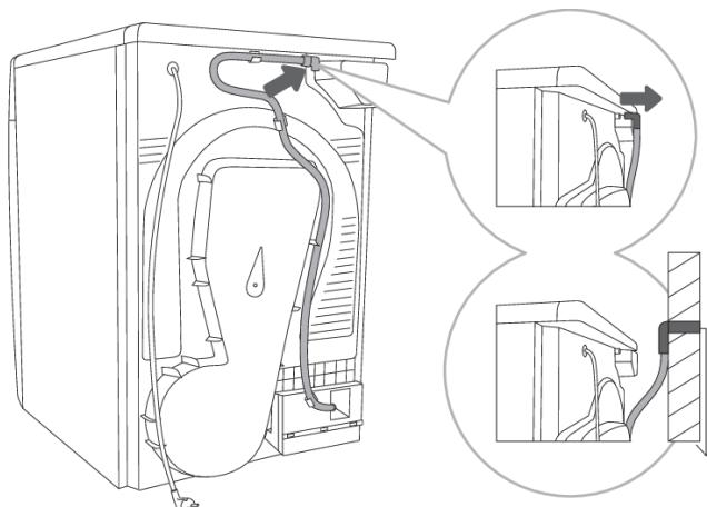
**1** Снимите шланг с патрубка на задней стенке машины (слева под крышкой).
