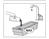
**3** Öffnen Sie die Abdeckung. Spülen Sie den Wasserbehälter mit Wasser aus. Setzen Sie den Wasserbehälter zusammen. Füllen Sie den Wasserbehälter vor dem Gebrauch mit frischem Wasser bis zur Markierung MAX.
