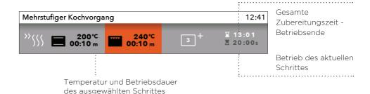
Nach Betätigung der Taste START beginnt der Backofen zuerst nach Schritt 1 zu arbeiten (auf dem unteren Teil des Displays wird auf dem Balken angezeigt, nach welchem Schritt der Back-/Bratvorgang ausgeführt wird). Nachdem die eingestellte Zeit abgelaufen ist, werden die Schritte 2 und 3 aktiviert – wenn Sie diese gewählt haben.
