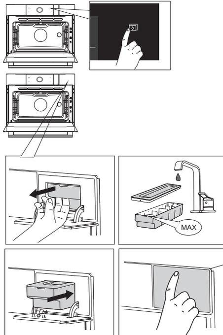
1. Drücken Sie auf die Taste „Wasserbehälter öffnen“, um die Klappe des Wasserbehälters zu öffnen.
