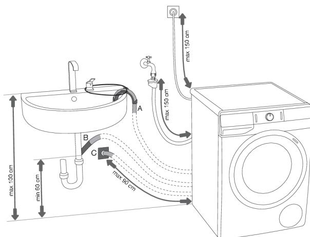
**A** Odvodnu cijev moguće je namjestiti u umivaonik ili kadu za kupanje. Kroz otvor u plastičnom koljenu odgovarajućim konopcem pričvrstite cijev da ne klizne na pod.
