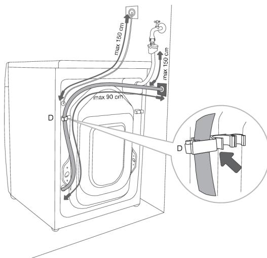
**D** Odvodna cijev mora biti pričvršćena i zakvačena na klin na stražnjoj stranici perilice rublja, kao što je prikazano na slici.
