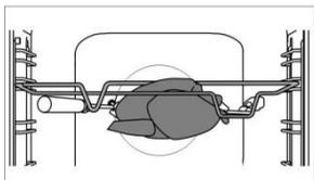
Tre kjøttet inn på spiddet og stram skruene. Plasser spiddhåndtaket på fremre spiddholder, og sett spissen inn i åpningen på høyre side innerst i ovnsrommet (åpningen er beskyttet med et dreibart deksel). Løsne spiddhåndtaket og lukk ovnsdøren.
