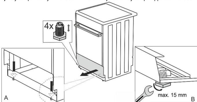
**B)** Høyden på komfyren er 900 mm. Du kan justere høyden på apparatet fra 850 til 920 mm eller fra 900 til 920 mm (modellavhengig).
