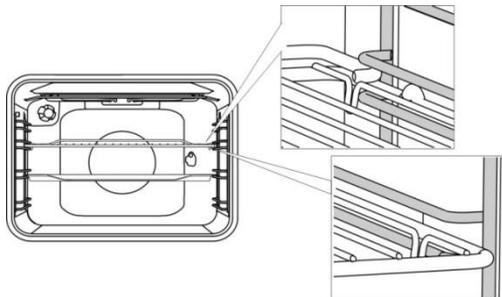
Med uttrekkbare teleskopskinner trekker du først ut skinnene på ett nivå og setter rist eller stekebrett på dem. Så skyver du dem inn med hånden så langt det går an.
