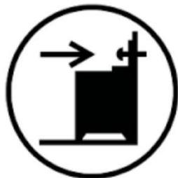
**ADVARSEL:** Stabiliseringsenheter må monteres for å hindre at komfyren tipper. Se monteringsveiledningen.
