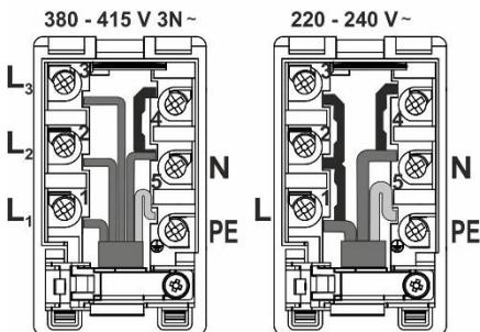
Det anbefales å bruke en trefase-tilkobling for komfyren, ved hjelp av en H05Z1Z1-F5G1,5 (H05VV-F5G1,5)-type forbindelsesledning (tidligere CGLG 5Cx1,5), (sikring 3x16 A). For enfase-tilkobling brukes en H05Z1Z1-F3G4 (H05VV-F3G4) (tidligere GGLG 3Cx4), (sikring 32 - 40 A, avhengig av type).
