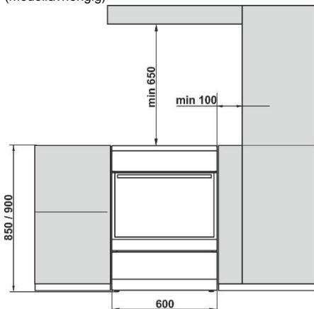
Veggene og innredningen nærmest apparatet (gulv, kjøkkenvegg, sidevegger) må tåle temperaturer på minst 90°C.
