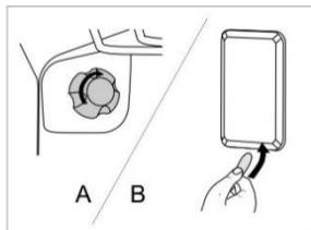
**A** Entfernen Sie die Abdeckung der Garraumleuchte und schrauben Sie das Lämpchen heraus.
