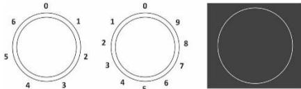
Die Heizleistung der Kochzonen kann stufenlos (1-9) oder stufenweise (1-6) eingestellt werden.
