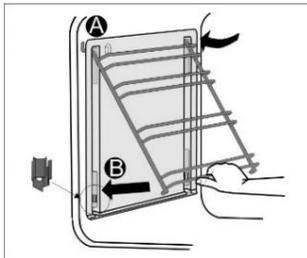
Platzieren Sie die Drahtführungen mit den katalytischen Einsätzen auf die oberen Öffnungen in den Seitenwänden des Garraums „A“. Drücken Sie sie in den Schnappverschluss an der Unterseite „B“.
