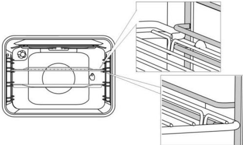
Wenn Ihr Gerät Teleskop-Ausziehführungen besitzt, ziehen Sie diese zuerst bei einer Einschubebene heraus und legen Sie den Rost oder das Backblech darauf. Schieben Sie dieses danach mit der Hand in den Garraum.
