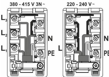
Schließen Sie das Gerät mit einem dreidadrigen Kabel vom Typ H05VV-1.5 (früher CGLG 5Cx1.5) an (Schutzschalter 3x16 A). Verwenden Sie für den einphasigen Anschluss ein Kabel vom Typ H05VV-F3G-4 (früher GGLG3Cx4) (Schutzschalter 32 – 40 A).
