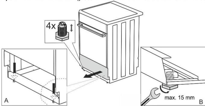
B) Die Höhe des Herdes beträgt 900 mm. Die Höhe des Geräts kann zwischen 900 und 920 mm eingestellt werden.
