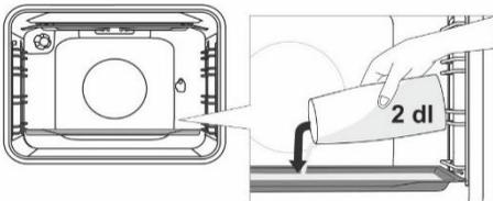
Schieben Sie ein Backblech in die erste Führung, während der Backofen noch kalt ist. Gießen Sie maximal 2 dl Wasser auf das Backblech. Legen Sie das Bratgut auf den zweiten Rost und starten Sie den Bratvorgang.
