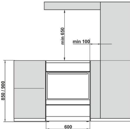
Die Wände oder Küchenmöbel, die an das Gerät angrenzen (Boden, Küchen-Rückwand, Seitenwände), müssen mindestens 90°C temperaturbeständig sein.
