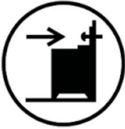
**ACHTUNG:** Um zu verhindern, dass das Gerät umkippt, sind Mittel zur Stabilisierung anzubringen. Lesen Sie dazu die bitte die Einbauanweisungen.
