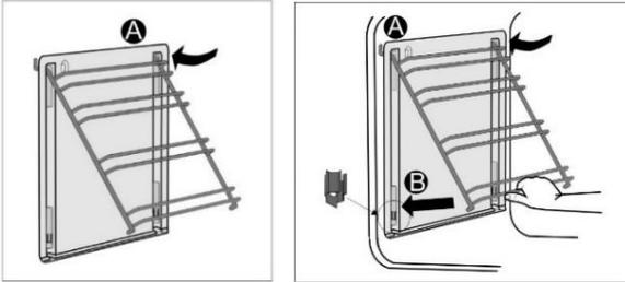
Platzieren Sie die Drahtführungen mit den katalytischen Einsätzen auf die oberen Öffnungen in den Seitenwänden des Garraums „A“. Drücken Sie sie in den Schnappverschluss an der Unterseite „B“.
