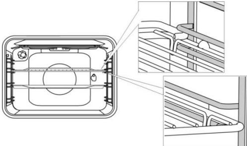
Wenn Ihr Gerät Teleskop-Auszieführungen besitzt, ziehen Sie diese zuerst bei einer Einschubebene heraus und legen Sie den Rost oder das Backblech darauf. Schieben Sie dieses danach mit der Hand in den Garraum.
