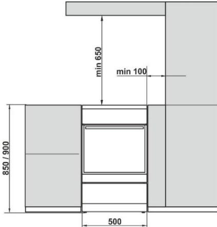
Die Wände oder Küchenmöbel, die an das Gerät angrenzen (Boden, Küchen-Rückwand, Seitenwände), müssen mindestens 90°C temperaturbeständig sein.
