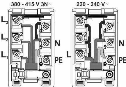
Schließen Sie das Gerät mit einem dreidrigen Kabel vom Typ H05VV-F5G1,5 (früher CGLG 5Cx1.5) an (Schutzschalter 3x16 A).
