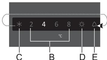
Brojke 2, 4, 6 i 8 znače temperature u °C u hladnjaku uređaja.
