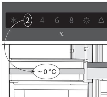
Da bi temperatura u pretincu **ZeroZone** bila oko 0 °C, preporučujemo da temperaturu hladnjaka podesite ispod 4 °C. Temperatura u pretincu **ZeroZone** može se spustiti i ispod 0 °C, stoga namirnice osjetljive na zamrzavanje premjestite u gornje predjele hladnjaka.
