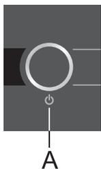
**Uključenje uređaja:** uređaj upućujete u rad pritiskom na tipku **A** koju držite pritisnuta 3 sekunde.
