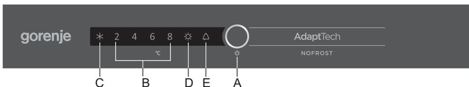
**A** Tipka za uključenje i isključenje uređaja te ugađanje temperature i dodatnih funkcija
