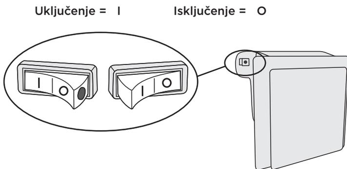
Kada je ionizator uključen, na prekidaču je vidljiva crvena točka.
