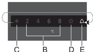
U slučaju previše povećane temperature u uređaju, uključuje se zvučni alarm (isprekidan ton zvuka) i bljeska simbol **E**.
