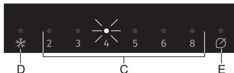
Si la température est trop élevée à l'intérieur de l'appareil, un signal sonore intermittent retentit et le voyant au-dessus de la température réglée (**C**) se met à clignoter.
