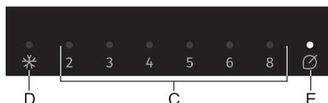
**Pour activer la fonction Eco**, appuyez sur la touche **B** jusqu'à ce que le voyant au-dessus de l'icône **E** s'allume. Lorsque cette fonction est active, l'appareil fonctionne avec des réglages optimaux.
