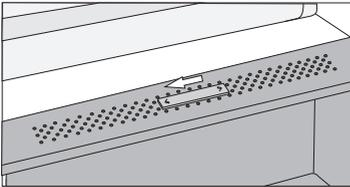
**Skjutreglage till vänster:** öppna ventiler, lägre luftfuktighet i lådan
