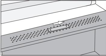
**Skjutreglage till höger:** stängda ventiler, högre luftfuktighet i lådan
