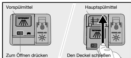
Füllen Sie bei Verwendung von Pulver- oder Flüssigspülmittel eine kleine Menge Spülmittel in das Fach für Vorspülmittel.
