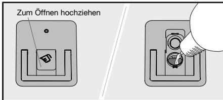
1. Öffnen Sie den Deckel des Fachs für die automatische Dosierung von flüssigem Geschirrspülmittel (Gel).
