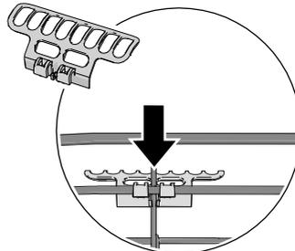
Setzen Sie den Besteckkorb so in die Maschine, dass Sie Platz für eine maximale Beladung erhalten. (Im beiliegenden Kunststoffbeutel enthalten.)
