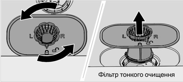
1. Поверніть кріпильне кільце проти годинникової стрілки та підніміть фільтр тонкого очищення, не нахилиючи.
