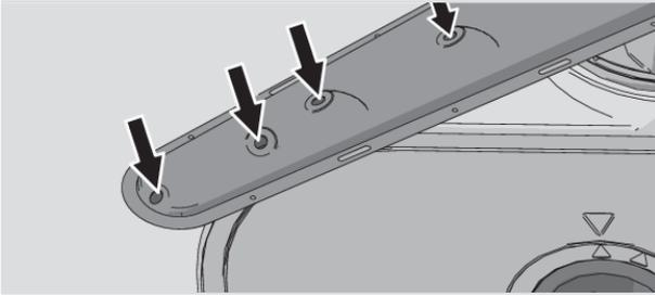
Для полегшення очищення можна зняти розбризкувачі. Після очищення не забудьте щільно закріпити їх на місці.
