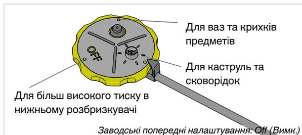
Залишіть зони посиленого миття Power Zone відкритими, якщо ви хочете збільшити потік води, де, наприклад, ви розмістили каструлі та сковорідки або вази та крихкі предмети. Відключіть зони посиленого миття, якщо ви хочете збільшити тиск у нижньому розбризкувачі.
