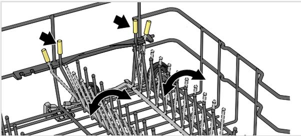
En la parte posterior del lado derecho del cesto inferior, las guías abatibles se pueden empujar juntas para proporcionar más espacio para, por ejemplo, objetos de barro o una sartén honda.
