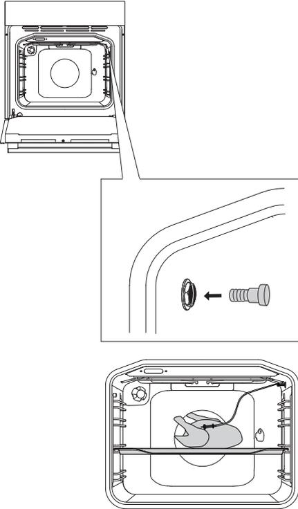
**1** Entfernen Sie den Metallzapfen von der Buchse zum Anschließen der Fleischsonde in der oberen linken Ecke des Garraums.
