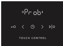
Sobald die Fleischsonde angeschlossen ist, stellen Sie das Programm und die Temperatur ein. Auf dem Display erscheint 3 Sekunden lang das Wort „Prob“. Danach wird auf dem Display die Ikone der Fleischsonde angezeigt (solange die Fleischsonde angeschlossen ist). Andere aktive Funktionen werden auf dem Display nicht angezeigt.
