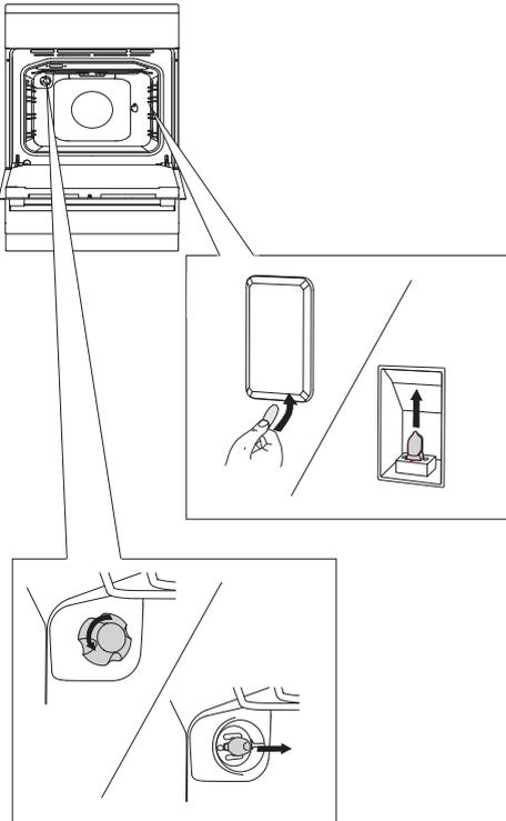
Heben Sie die Abdeckung der Garraumleuchte mit einem Schraubenzieher an und entfernen Sie sie. Entfernen Sie das defekte Leuchtmittel.
