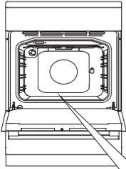
**1** Drehen Sie den WAHLKNEBEL für die BEHEIZUNGSART auf die Position AQUA CLEAN. Stellen Sie die Temperatur mit dem TEMPERATURWAHLKNEBEL auf 70°C ein.
