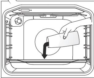
**2** Gießen Sie 0,6 l Wasser in einen Glasbräter oder ein niedriges Backblech und schieben Sie es in die untere Führung.
