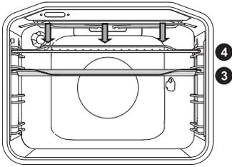
Bei der Beheizungsart **Großflächengrill** sind die Oberhitze und das an der Garraumdecke angebrachte Infrarot-Heizelement in Betrieb.
