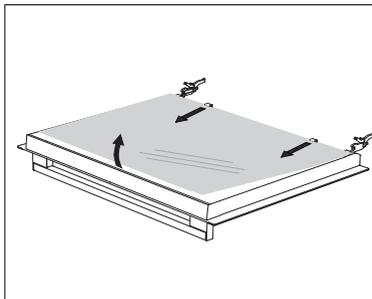
**1** Lösen Sie die Schrauben der Träger auf beiden Seiten der Gerätetür.
