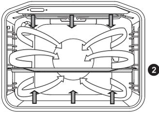
Diese Funktion ermöglicht ein schonendes, langsames und gleichmäßiges Braten; das Bratgut bleibt weich und saftig. Diese Beheizungsart wird zum Braten auf einer Einschubebene verwendet.
