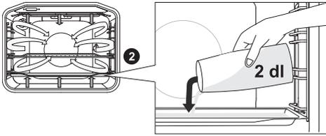
Schieben Sie ein Backblech in die erste Führung, während der Backofen noch kalt ist. Gießen Sie maximal 2 dl Wasser auf das Backblech. Legen Sie das Bratgut auf den zweiten Rost und starten Sie den Bratvorgang.
