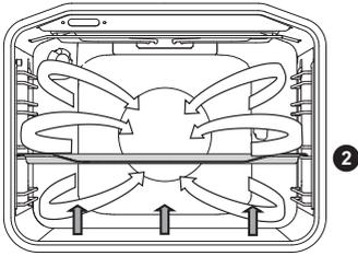
Diese Beheizungsart ist vor allem zum Backen von niedrigem Backgut und zum Einkochen von Obst und Gemüse geeignet. Verwenden Sie die 2. Führung von unten und nicht allzu hohe Backbleche, damit die erhitzte Luft auch auf der Oberseite des Backguts kreisen kann.
