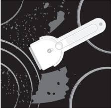
**Entfernen Sie Wasserflecken** mit einer milden Essiglösung; den Rahmen des Kochfeldes (nur bei einigen Modellen) dürfen Sie damit nicht abwischen, weil er dadurch den Glanz verliert. Verwenden Sie keine aggressiven Sprays und Kalkentfernungsmittel.
