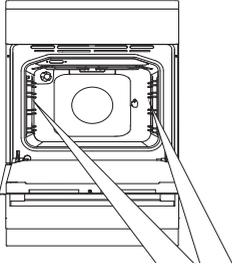
Entfernen Sie die Drahtführungen bzw. Teleskop-Ausziehführungen.
