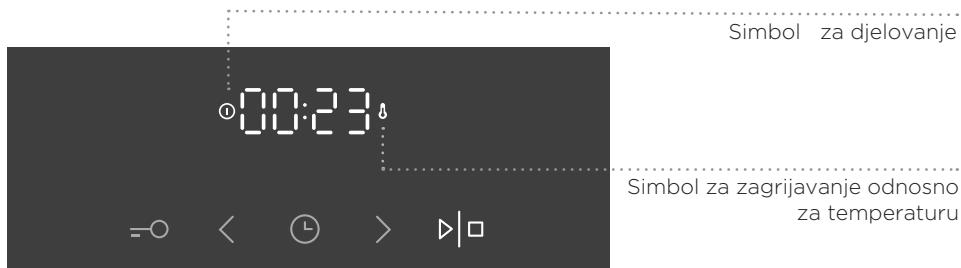
Kada pećnica postigne odabranu temperaturu, začuje se kratak zvučni signal, a nakon određenog vremena simbol za temperaturu se ugasi.
