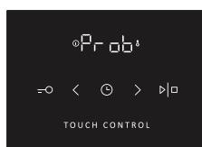
Kada je temperaturna sonda za meso priključena, odaberite program pečenja i temperaturu. Na pokazivaču se ispše obavijest „Prob“ koja ostaje aktivna otprilike 3 sekunde. Zatim se na zaslonu prikaže ikona (sonda za meso), koja ostaje vidljiva sve dok je sonda priključena.
