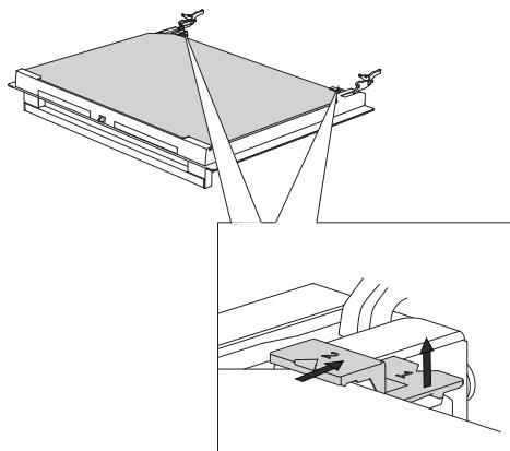
**1** Ανασηκώστε ελαφρώς τα στηρίγματα στην αριστερή και δεξιά πλευρά της πόρτας (ένδειξη 1 στο στήριγμα) και τραβήξτε τα από τον υαλοπίνακα (ένδειξη 2 στο στήριγμα).
