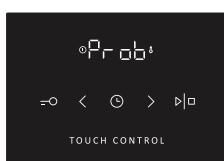
Όταν συνδεθεί το θερμόμετρο κρέατος, επιλέξτε το επιθυμητό πρόγραμμα μαγειρέματος και θερμοκρασίας. Η ένδειξη “Prob” θα εμφανιστεί στην οθόνη για 3 δευτερόλεπτα. Στη συνέχεια, το εικονίδιο (θερμόμετρο κρέατος) θα εμφανιστεί στην οθόνη και θα παραμείνει εκεί για όσο διάστημα ο αισθητήρας είναι συνδεδεμένος. Όλες οι άλλες ενεργές λειτουργίες θα ακυρωθούν ή θα διαγραφούν.
