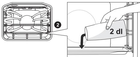
Τοποθετήστε το ρηχό ταψί στον πρώτο οδηγό ενώ ο φούρνος είναι ακόμα κρύος. Ρίξτε το πολύ 200ml νερό στο ταψί. Τοποθετήστε το φαγητό που θα μαγειρευτεί στη δεύτερη σχάρα και εκκινήστε το σύστημα.
