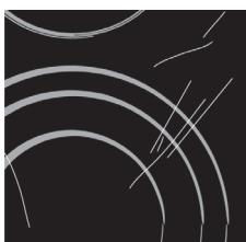
**Před každým použitím** sklokeramického povrchu utřete špínu nebo jiné nečistoty, které by mohly poškrábat povrch, z varné desky a dna nádobí.
