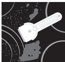
**Škrabku používejte výhradně, pokud se špína nedá odstranit vlhkou utěrkou nebo speciálními čističi pro sklokeramické povrchy.**
