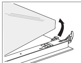
**2** Возьмите стекло дверцы за нижний край, немножко приподнимите, чтобы оно освободилось из фиксаторов, и снимите.
