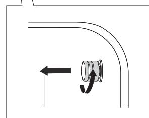
**1** Выньте металлическую заглушку (гнездо для зонда расположено в переднем верхнем углу на правой стенке духовки).
