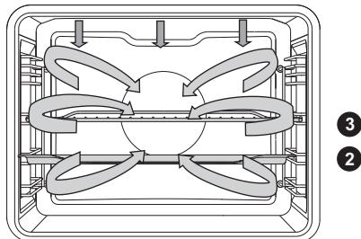
Одновременно работают верхний нагревательный элемент, инфранагреватель и нагревательный элемент вокруг вентилятора. Используется для приготовления всех видов мяса.
