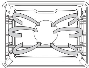
Одновременно работают нагревательный элемент вокруг вентилятора и вентилятор. Вентилятор создает постоянную циркуляцию горячего воздуха вокруг мяса или выпечки.
