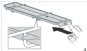
**1** Испарительная емкость установлена справа, под потолком духовки, на нагревателе гриля.
