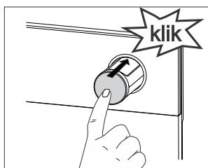
**1** Нажмите на кнопку резервуара для воды и извлеките резервуар. При нажатии на кнопку резервуар выдвигается из гнезда.
