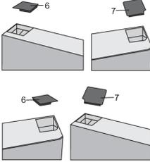
Quitar la tapa (6) del lado izquierdo de la puerta superior. Luego quitar la tapa (7) del lado derecho de la puerta superior. Colocar la tapa (7) en el lado izquierdo de la puerta superior y colocar la tapa (6) en el lado derecho de la puerta superior.
