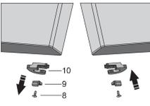
Colocar la puerta inferior sobre una superficie lisa. Desenroscar el tornillo (8) y retirar el retenedor de la puerta (10) y el tope de la puerta (9). En el lado opuesto utilizar el tornillo (8) para instalar el retenedor de la puerta suministrado en la bolsa, y el tope de la puerta (9). Guardar el retenedor de la puerta (10) por si lo necesita más tarde.
