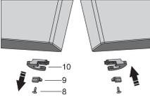
Desenroscar el tornillo (8) y retirar el retenedor de la puerta (10) y el tope de la puerta (9). Luego, utilizar el tornillo (8) para instalar el retenedor de la puerta suministrado en la bolsa, y el tope de la puerta (9). Guardar el retenedor de la puerta (10) por si lo necesita más tarde.
