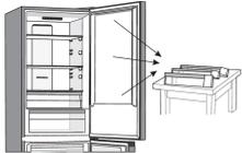
Coloque el aparato en posición vertical. Abra la puerta superior y retire las rejillas de la puerta (para evitar que se dañen durante el procedimiento). Cierre la puerta.
