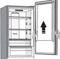
Retirar la puerta superior de la bisagra central levantándola con cuidado en línea recta hacia arriba. Colocar la puerta sobre una superficie lisa.
