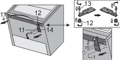
Aflor los tres tornillos de la bisagra inferior (14) y extráigala. Retire la pata adicional (12) del pasador de la bisagra inferior (13). Desatornille el pasador (13) de la bisagra inferior y atornillelo en el lado opuesto de la bisagra, junto con la pata adicional (12).
