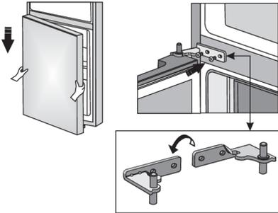
Colocar la puerta inferior en la bisagra inferior y mantenlos en su lugar. Girar la bisagra central 180°. Colocar la arandela en la posición correcta y ajustar la posición de la bisagra central para poder instalar y fijar la puerta inferior.
