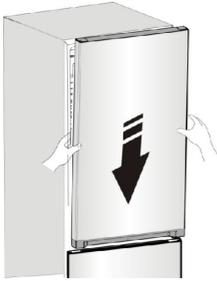
Colocar la puerta superior en la posición correcta y usar los tornillos (2) para fijar la bisagra superior (3). Mantener la puerta superior en su lugar mientras la coloca.
