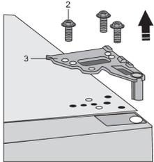
Desatornillar los tornillos (2) y retirar la bisagra (3). Sujetar la puerta mientras se hace esto para evitar que se caiga.
