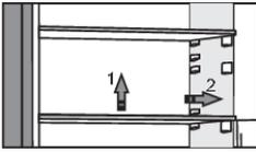
Puede colocar los estantes vacíos a su gusto utilizando las guías que hay en el interior del frigorífico sin tener que sacarlos del frigorífico. Para mover el estante o sacarlo del frigorífico, levántelo ligeramente por la parte trasera, tire de él hacia usted, y luego muévalo o sáquelo del electrodoméstico. Almacene los alimentos perecederos en la parte posterior del estante donde la temperatura es más baja.
