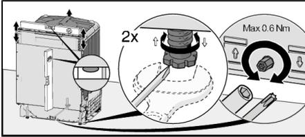
4. Überprüfen Sie, ob ein Luftspalt von mindestens 3 mm zwischen der Unterseite der Arbeitsplatte und der Oberseite des Geschirrspülers freigelassen wurde.
