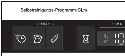
Halten Sie die Auswahl-tasten Selbstreinigungs-Programm lang gedrückt, um das Programm zu aktivieren. Selbstreinigungs-Programm startet, sobald die Tür geschlossen wird.
