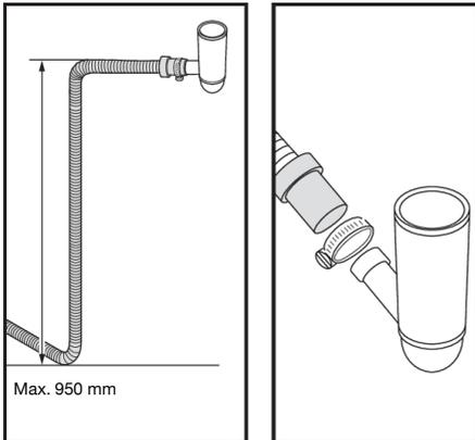
Der Ablaufschlauch kann auch mit einem Anschlussnippel in der Wasserleitung des Ablaufes verbunden werden. Der Anschlussnippel muss einen Innendurchmesser von mindestens 14 mm haben.
