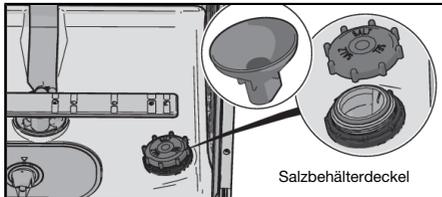
1. Schrauben Sie den Deckel des Salzbehälters ab.
