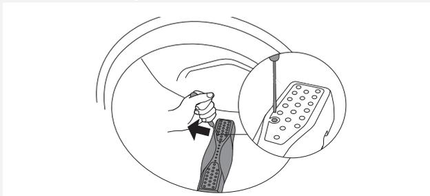
**1** Insira uma chave-de-fendas ou uma ferramenta similar no orifício da pá e empurre-a para a esquerda.
