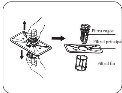
Sistemul de filtrare conține un filtru rugos, un filtru plat (Filtru principal) și un micro filtru (Filtru fin).
