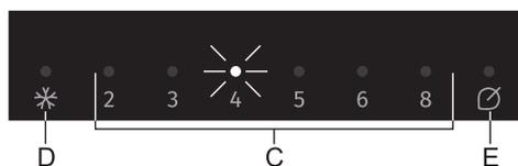
U slučaju previše povećane temperature u unutrašnjosti uređaja, uključuje se zvučni alarm (**isprekidan ton zvuka**) i bljeska signalna lampica iznad odabrane temperature **C**.
