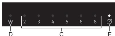
**Uključenje:** Eco funkciju uključite tako da tipku **B** pritisnete toliko puta da zasvijetli signalna lampica iznad simbola **E**. Tada uređaj djeluje na optimalnim postavkama.
