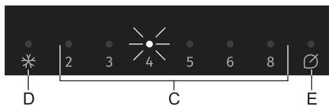
U slučaju previše povećane temperature u unutrašnjosti aparata, uključuje se zvučni alarm (**isprekidan ton zvuka**) i trepće signalna lampica iznad izabrane temperature **C**.
