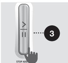
2. Drücken Sie die Taste (3) **START/PAUSE**. Das Gerät beginnt mit der Messung des Gewichtes der Wäsche in der Trommel.
