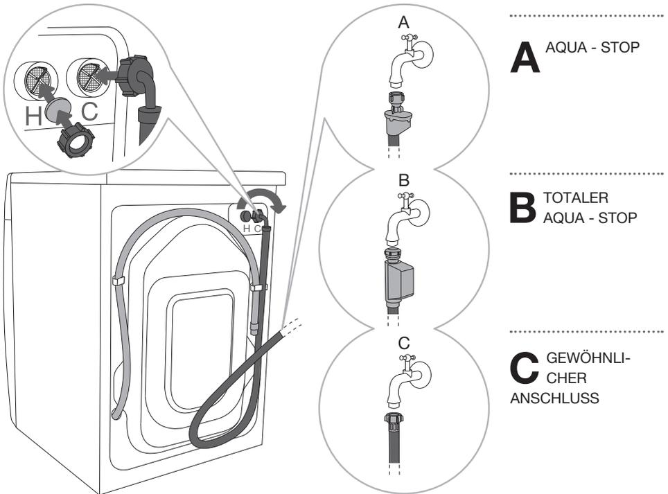
☞ Falls Ihr Gerät über einen Warm- und Kaltwasseranschluss verfügt und Sie das Gerät nur an den Kaltwasseranschluss anschließen möchten, sollten Sie den Warmwasser-Zulaufschlauch an der Rückseite der Waschmaschine nicht montieren und die Öffnung an der Rückseite des Geräts mit dem beigelegten Stopfen schließen.
