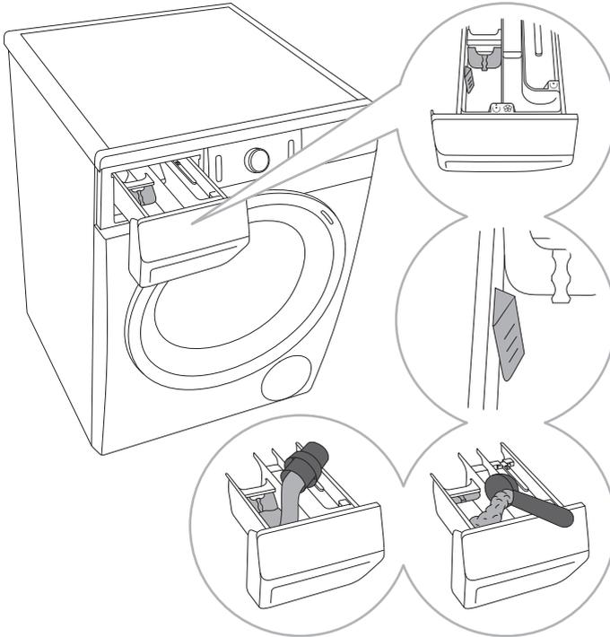
**1** Der Waschmaschine ist eine Fach-Trennwand beigelegt, damit Sie im Waschmittelfach ☺ (linkes Fach) auch Flüssigwaschmittel verwenden können.
