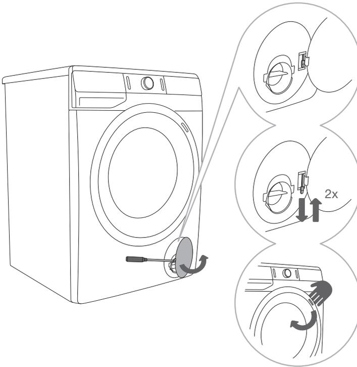
**1** Öffnen Sie bei einer Unterbrechung des Waschprogramms die Filterabdeckung (mit einem Werkzeug (Schraubenzieher o.Ä.).
