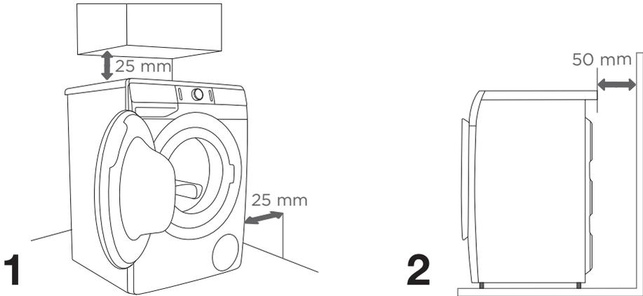
☼ Das Gerät darf die Wand oder die benachbarten Küchenelemente nicht berühren. Für eine optimale Funktion der Waschmaschine empfehlen wir, den Abstand zur Wand zu berücksichtigen, wie es auf der Abbildung dargestellt ist.
