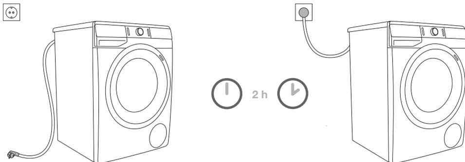
**⚠** Bevor Sie die Waschmaschine an das Stromnetz anschließen, muss diese mindestens 2 Stunden ruhen, damit sie sich an die Zimmertemperatur anpasst.
