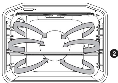
Желдеткіштің айналасындағы қыздыру элементі және желдеткіш бір уақытта жұмыс жасайды. Желдеткіш еттің немесе пісірменің айналасында ыстық ауаның тұрақты айналымын тудырады.
