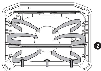
Төменгі қыздыру элементі, желдеткіштің айналасындағы қыздыру элементі және желдеткіш бір уақытта жұмыс жасайды. Бұл режимді пицца, алма бәлішін және жеміс торттарын пісіру үшін қолданған дұрыс.
