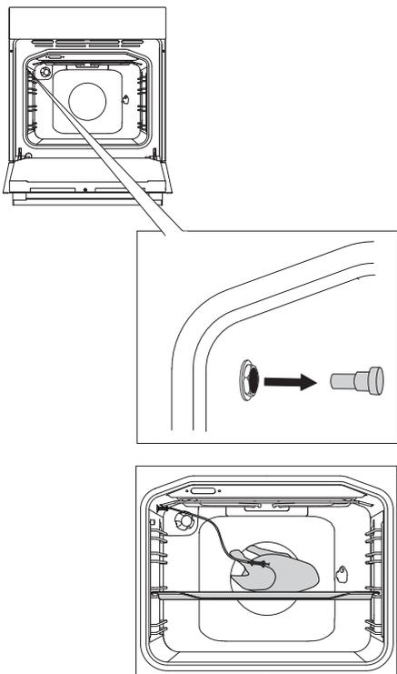
**1** Выньте металлическую заглушку (гнездо для зонда расположено в переднем верхнем углу на правой стенке духовки).
