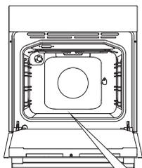
**1** Поверните ПЕРЕКЛЮЧАТЕЛЬ РЕЖИМА НАГРЕВА в положение AquaClean. ПЕРЕКЛЮЧАТЕЛЕМ ТЕМПЕРАТУРЫ установите температуру 70°С.
