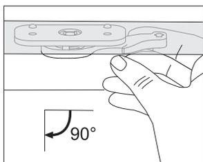
Чтобы разблокировать замок, откройте дверцу духовки и указательным пальцем потяните замок на себя. Замок дверцы разблокирован (в рабочем состоянии).
