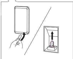
S ploščatim izvijačem sprostite pokrov žarnice in ga odstranite. Izvlecite žarnico.
