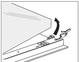
**2** Steklo vrat primepite na spodnjem robu, ga rahlo privzdignite, da se iztakne iz nosilca in odstranite.
