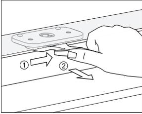
Öffnen Sie die Verriegelung, indem Sie sie mit dem Daumen nach rechts drücken und die Backofentür gleichzeitig zu sich ziehen.
