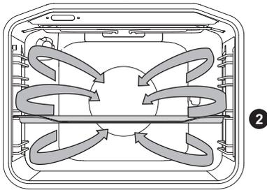
Gleichzeitig sind der Ringheizkörper und das Gebläse in Betrieb. Das Gebläse an der Rückwand des Garraums sorgt für ständiges Kreisen der heißen Luft um das Brat-/Backgut.
