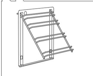
Entfernen Sie die Draht- bzw. Ausziehführungen.
