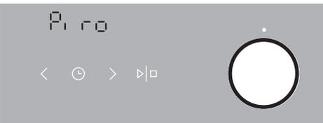
**2** Drehen Sie den Temperaturwahlknebel ganz nach links auf die Position P. Auf dem Display beginnen das Wort „Pyro“ und die dazugehörige Zeitanzeige für die Dauer der pyrolytischen Reinigung zu blinken. Berühren Sie die Taste Start/Stop.
