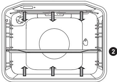
Die Heizelemente im Ober- und Unterteil des Garraums strahlen die Hitze gleichmäßig in den Garraum.
