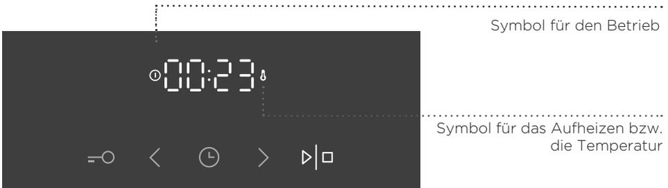
Während des Aufheizens des Garraums blinkt das Symbol der Temperatur. Sobald die eingestellte Temperatur erreicht ist, leuchtet das Symbol auf und es ertönt ein kurzes akustisches Signal.
