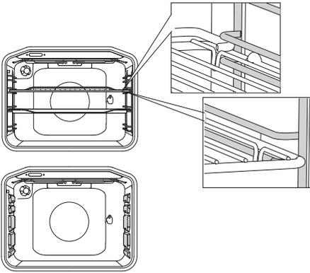
Bei Drahtführungen müssen Sie den Rost und die Backbleche immer in die Führungsrinne der Drahtführungen einschieben.
