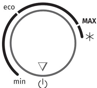
**Выключение прибора:** Поверните переключатель **A** обратно в положение
