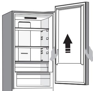
5. Võtke kotist (parem) otsak/kate (4) ja pange see kohale, kust ülemise hinge eemaldasite. Eemaldage ja jätkke käepärast otsak/kate teiselt poolt (5), kuhu hinge ümber paigutate.
