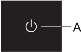
Cuando el dispositivo se conecta a la red eléctrica por primera vez, estará en modo de espera (apagado, pero bajo tensión eléctrica).
