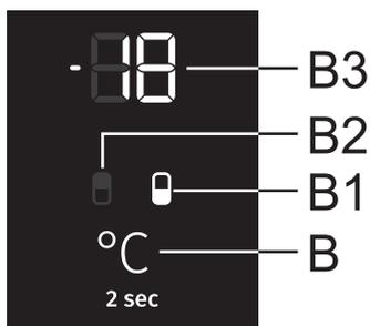
La temperatura en la parte del **congelador** se puede configurar cuando se ilumina el símbolo **B1**. La temperatura se establece presionando brevemente la tecla **B**.
