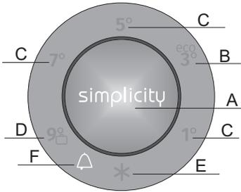
Si la temperatura en el electrodoméstico es demasiado alta, se activará una alarma acústica (**Tono interrumpido**), y parpadea el símbolo **F**.
