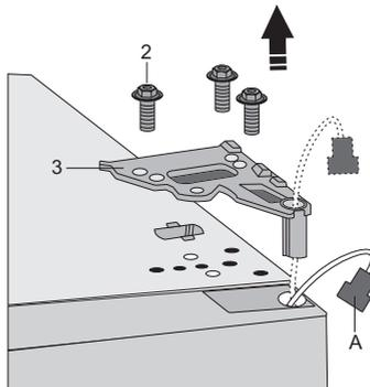
4. Retirar la puerta superior de la bisagra central levantándola con cuidado en línea recta hacia arriba. Colocar la puerta sobre una superficie lisa.
