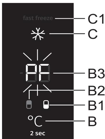
Si el aparato se calienta a una temperatura de alarma durante un corte de energía, la alarma de temperatura alta se activa cuando se restablece la energía. Suenan una alarma sonora y en el visualizador **B3** parpadea **PF**.
