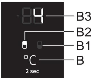
Con este modelo, es posible cambiar entre el ajuste de la temperatura del compartimiento del refrigerador y del congelador. Para ello, presionar la tecla **B** durante dos segundos para iluminar el símbolo de la parte del aparato cuya temperatura desea establecer: **B1** para la parte del congelador y **B2** para la parte del refrigerador.
