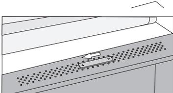
**La posición del deslizador a la izquierda:** orificios abiertos - menor humedad en el contenedor.
