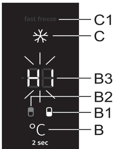
Si la temperatura del aparato es demasiado alta, se activará una alarma acústica (**tono interrumpido**), y en el visualizador **B3** parpadea **HI** mientras se ilumina el símbolo de la parte del aparato en la que la temperatura es demasiado alta (**B1** o **B2**).
