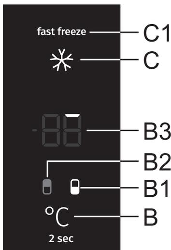
**Encendido:** presionar la tecla **C** para encender la congelación intensiva. Escuchará un pitido y se ilumina la visualización **B1** y **C1**.
