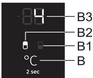
La temperatura en la parte del **refrigerador** se puede configurar cuando se ilumina el símbolo **B2**. La temperatura se establece presionando brevemente la tecla **B**.
