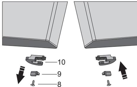
8. Desenroscar los tornillos de la bisagra central y retirarla. Luego, retirar la puerta inferior de la bisagra inferior.
