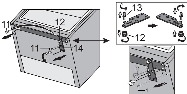
13. Fije la bisagra (14) en el lado opuesto, con los tornillos. Los tornillos deben colocarse en el orden que se muestra en la siguiente figura. Primero, ajuste el tornillo 1, seguido de los tornillos 2. Luego, atornille las patas ajustables (11).
