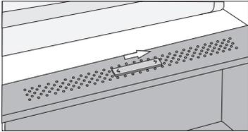
**La posición del deslizador a la derecha:** orificios cerrados - mayor humedad en el contenedor.
