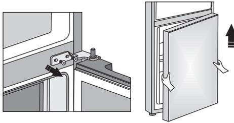
9. Colocar la puerta inferior sobre una superficie lisa. Desenroscar el tornillo (8) y retirar el retenedor de la puerta (10) y el tope de la puerta (9). En el lado opuesto utilizar el tornillo (8) para instalar el retenedor de la puerta suministrado en la bolsa, y el tope de la puerta (9). Guardar el retenedor de la puerta (10) por si lo necesita más tarde.
