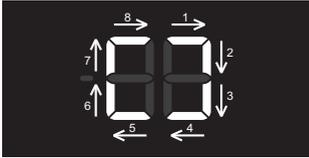
**Apagado del aparato:** para apagar el aparato debe mantener presionada (2 segundos) la tecla **A**. El pitido vuelve a sonar y en el visualizador **B3** se muestra la iluminación circular en sentido horario de los segmentos exteriores. El aparato está en modo de espera (todavía en bajo tensión eléctrica).
