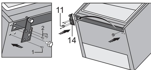
14. Colocar la puerta inferior en la bisagra inferior y mantenerlos en su lugar. Girar la bisagra central 180°. Colocar la arandela en la posición correcta y ajustar la posición de la bisagra central para poder instalar y fijar la puerta inferior.
