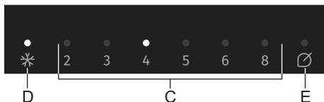
**Encendido:** Para activar la congelación intensiva, pulse la tecla **B** y manténgala pulsada hasta que se encienda la luz de señalización encima del símbolo **D**.
