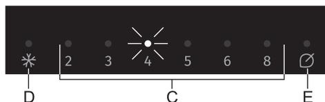
Si la temperatura en el interior del aparato es demasiado alta, se activará una alarma acústica (**tono intermitente**) y la luz de señal por encima de la temperatura establecida (**C**) comenzará a parpadear.
