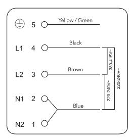
Falls die Gesamtanzahl der Kochzonen des Geräts nicht weniger als 4 beträgt, kann das Gerät, wie unten dargestellt, über eine einphasige elektrische Verbindung direkt an das Stromnetz angeschlossen werden.
