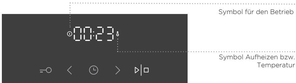
Sobald die eingestellte Temperatur erreicht ist, ertönt ein kurzes akustisches Signal, das Symbol für die Temperatur erlischt nach einer gewissen Zeit.
