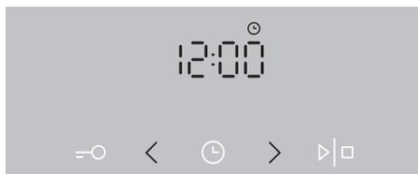
**1** Durch Berühren der Tasten < oder > kann die Tageszeit eingestellt werden; durch Berühren der Taste ☉ wird diese Einstellung bestätigt.
