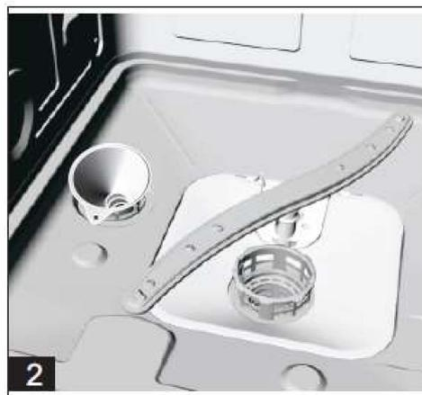
A. Retirez le panier inférieur, puis dévissez le bouchon du réservoir de sel et enlevez-le (fig. 1).
