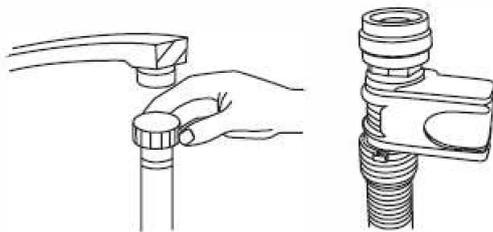
Raccordez le tuyau d'alimentation en eau froide à un robinet avec bout fileté de  $\frac{3}{4}$ " (pouce) et assurez-vous qu'il est fixé solidement. Si les conduites d'eau sont neuves ou n'ont pas été utilisées pendant une longue période, laissez couler l'eau pour vérifier qu'elle est claire et sans impuretés. Si vous ne prenez pas cette précaution, l'arrivée d'eau dans la machine risque d'être bloquée, ce qui pourrait endommager l'appareil.
