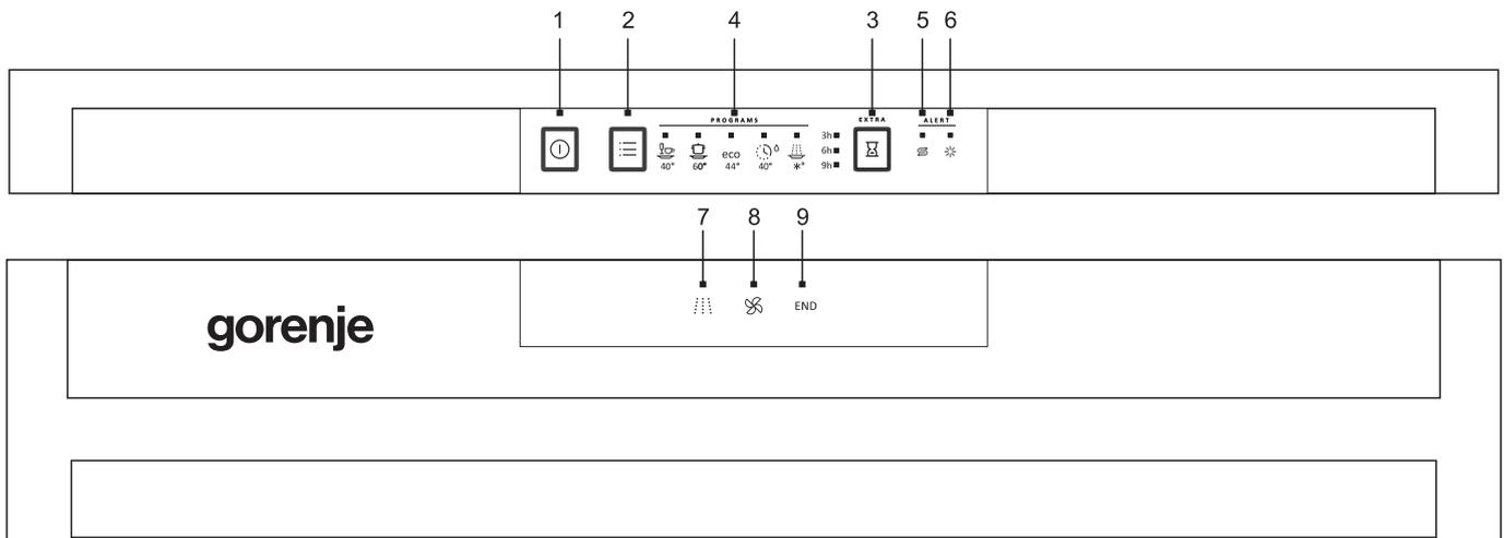
1. Interrupteur Marche/Arret: pour allumer/eteindre l'appareil.
