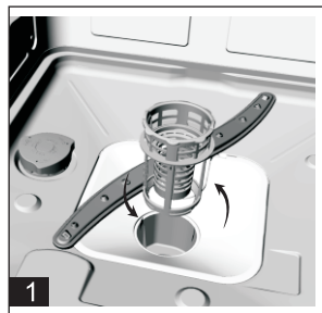
Schritt 1: Den Grobfilter kontrarotieren und dann anheben.
