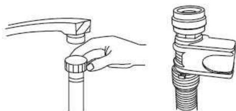
Raccordez le tuyau d'alimentation en eau froide à un robinet avec embout fileté de  $\frac{3}{4}$ " (pouce) et assurez-vous qu'il est fixé solidement. Si les conduites d'eau sont neuves ou n'ont pas été utilisées pendant une longue période, laissez couler l'eau pour vérifier qu'elle est claire et sans impuretés. Si vous ne prenez pas cette précaution, l'arrivée d'eau dans la machine risque d'être bloquée, ce qui pourrait endommager l'appareil.
