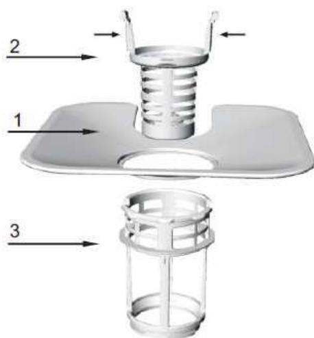
Le système de filtration comprend un filtre grossier, un filtre plat (filtre principal) et un microfiltre (filtre fin).
