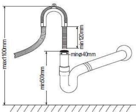
Fixez le tuyau de vidange de votre machine à la conduite d'évacuation des eaux usées sans le plier.
