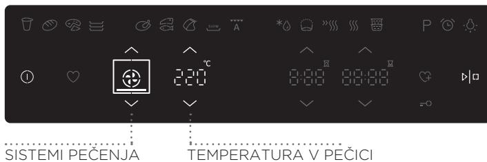
Z dotikanjem tipk ( $\wedge$ ) in ( $\vee$ ) izberite sistem in temperaturo v pečici.
