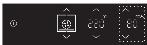
Po vklopu sonde se na prikazovalniku pojavi napis **Prob**. Nastavite željeno temperaturo. Dotaknite se tipke START.
