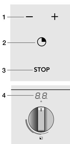
1. S tipko za programsko uro (2) izberite gorilnik, za katerega želite nastaviti samodejni izklop. Večkrat pritisnite tipko za programsko uro, dokler na prikazovalniku programske ure nad upravljalnim gumbom za izbrani gorilnik ne začne utripati "00" (4).
