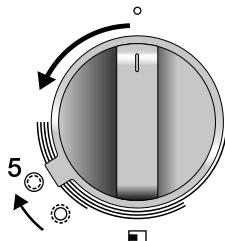
1. Pritisnite kontrolni gumb in ga obrnite v nasprotni smeri urnega kazalca. Gorilnik se bo prižgal.
